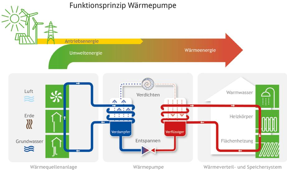
Eine Wärmepumpen-Heizungsanlage besteht aus drei Teilen: der Wärmequellenanlage, die der Umgebung die benötigte Energie entzieht, der eigentlichen Wärmepumpe, die die gewonnene Umweltwärme nutzbar macht sowie dem Wärmeverteils- und Speichersystem, das die Wärme im Haus verteilt oder zwischenspeichert.
