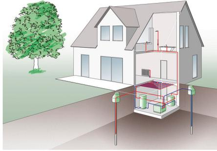
**Grundwasser** ist ein sehr guter Wärmespeicher mit ganzjährig relativ konstanten Temperaturen. Selbst an kalten Wintertagen besitzt das Wasser noch eine Temperatur von 7 bis 12 °C. Ist Grundwasser in ausreichender Menge und Qualität vorhanden, kann es als Wärmequelle genutzt werden. Wasser-/Wasser-Wärmepumpen werden jedoch vorwiegend für grössere Projekte eingesetzt.
