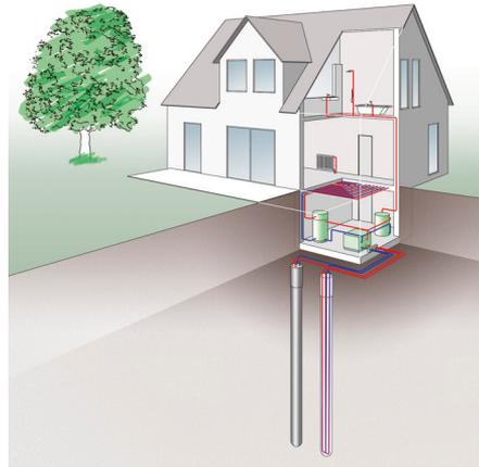
Bei **Erdwärmesonden** zirkuliert eine frostsichere Flüssigkeit, die Sole, in einem geschlossenen Kreislauf durch ein Kunststoffrohr im Erdreich. Da ab einer Tiefe von 10 Metern die natürliche, ungestörte Temperatur das ganze Jahr über nahezu konstant ist, ermöglicht die Erdwärmesonde eine besonders hohe Effizienz.
