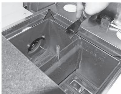
Fig. 71 Nettoyer les surfaces d'échange
