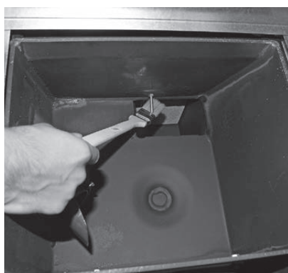
Fig. 51 Nettoyage de la sonde Thermocontrol
