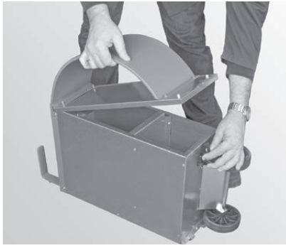
Fig. 49 Ouvrir le dispositif de fermeture à étrier de tension, retirer le couvercle et vider le cendrier
