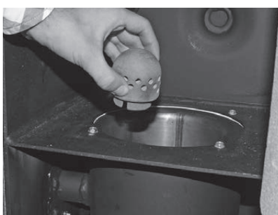
Fig. 59 Retirer la broche d'air primaire
