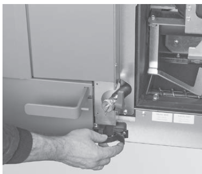
Fig. 46 Ouverture de la fermeture à étrier de tension
