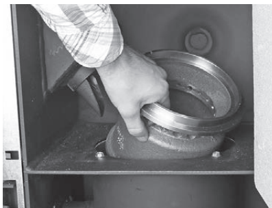
Fig. 55 Retirer le cône de partie inférieure
