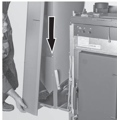
Fig. 81 Pousser le cache vers le bas et l'enlever (fermeture à baïonnette)
