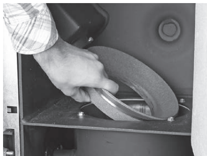
Fig. 54 Retirer le cône de partie supérieure
