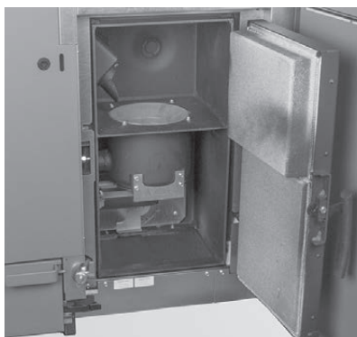
Fig. 40 Ouvrir la porte de revêtement et la porte de la chambre de combustion
