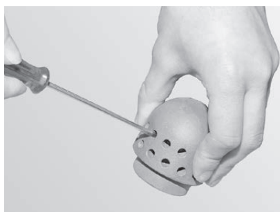
Fig. 60 Nettoyer la broche d'air primaire avec précaution
