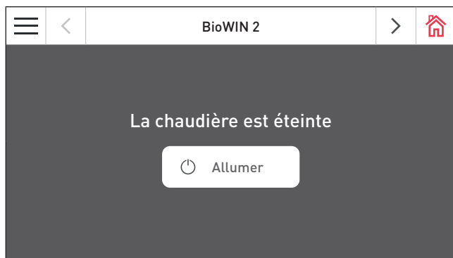
Fig. 31 La chaudière est éteinte
