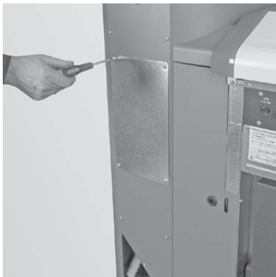
Fig. 82 Enlever les vis, retirer le couvercle de révision
